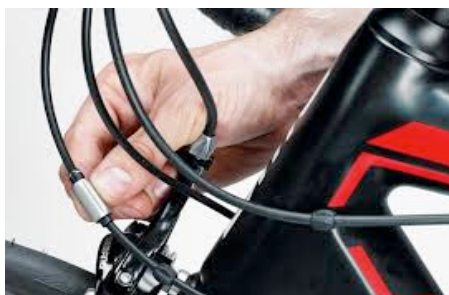
Above - Adjuster for chain ring (Front Derailleur)
